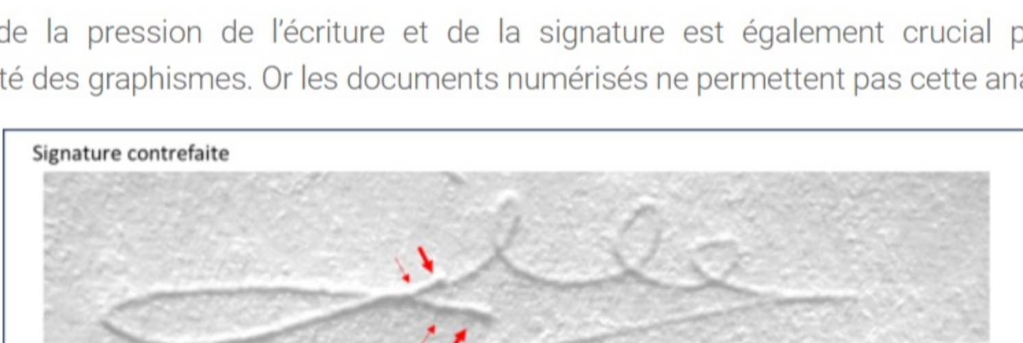
Figure 5 : Analyse de la pression d'une signature contrefaite : accentuation aux extrémités
