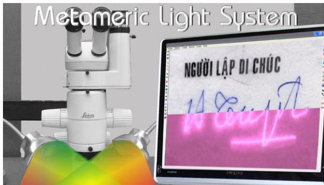
Microscope stéréoscope LEICA 7.5 avec lampes d'éclairages ML-SYS
