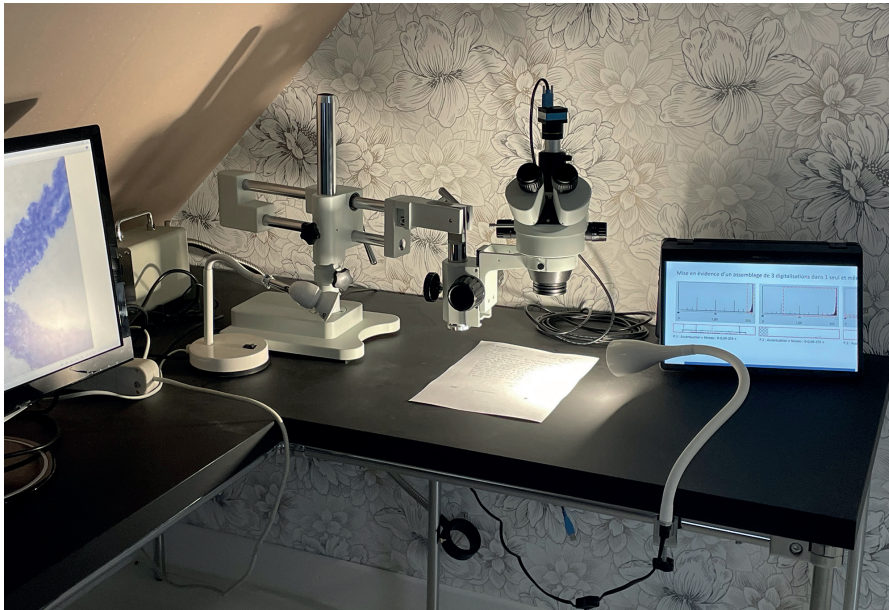
Photographie de laboratoire - Microscope trinoculaire stéréo avec anneaux lumineux à fibre optique LED supportant une caméra sensible aux rayonnements infrarouges (IR) et accompagné de divers sources lumineuses (tungstène, halogène comprenant blanc chaud, froid, neutre, LED) permettant plusieurs angles d'incidences dont la lumière rasante.
